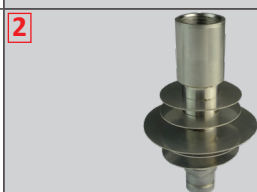
Refroidisseur avec embout de 14.5mm. Utilisé pour éloigner la tête des thermostats de la paroi dans des applications haute température. Se visse sur le filetage 3/8 BSPP sous le boîtier.
