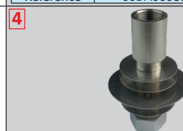
Refroidisseur avec écrou mobile 1/2" BSPP. Utilisé pour éloigner la tête des thermostats de la paroi dans des applications haute température. Se visse sur le filetage 3/8 BSPP sous le boîtier.
